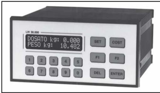
Strumento in custodia DIN 72 x 144 x 170 mm per montaggio fronte quadro. Foratura 67x138 mm. Display LCD alfanumerico retroilluminato 2 righe da 16 caratteri (altezza 5mm). Protezione del frontale IP 54. Fusibile di protezione accessibile dall'esterno.
