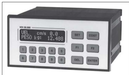
Strumento in custodia a norme DIN ( 72x144x170 mm, foratura 67x138mm) per montaggio fronte quadro. Display LCD alfanumerico retroilluminato, 2 righe da 16 caratteri (altez. 5 mm). Grado protezione del frontale IP 54. Fusibile di protezione accessibile dall'esterno. Il WN 30.000 oltre ad integrare le variabili di peso e velocità generando quindi la portata oraria istantanea ed il peso totalizzato, esegue anche la funzione di autoregolatore di portata.
